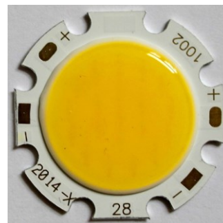
Obr. 1: LED COB (Chip On Board) s okrajovým zakřivením luminoforu [4].
