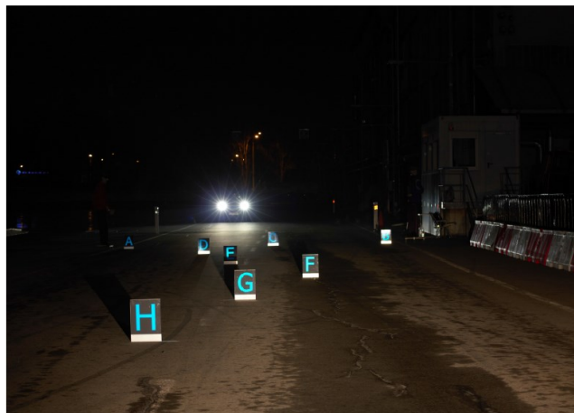
Obr.6. Potkávácí světla - 35 m bez VO s automobilem v protisměru
