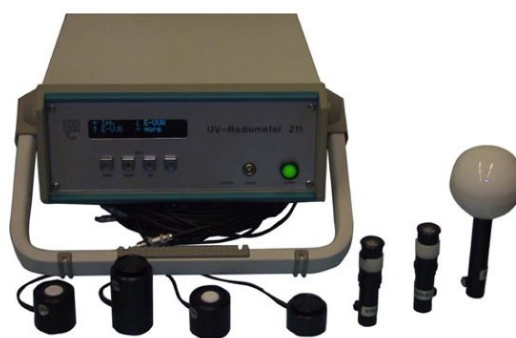
Obr. 5: Obrázek 9: PRC Krochmann Radiolux 211 s nástavci střední kulové (vpravo), válcové, poloválcové a planární osvětlenosti
