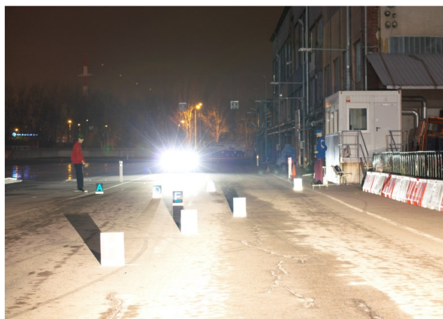
Obr.7. Dálková světla - 35 m bez VO s automobilem v protisměru
