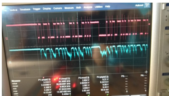
Fig.6. Průběh komunikace při slabém signálu.
