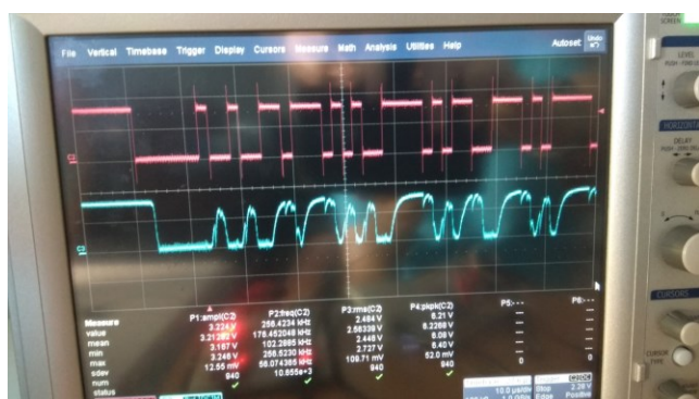
Fig.5. Průběh komunikace při 512kbaud.
