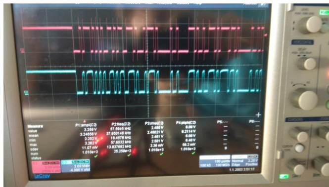
Fig.4. Komunikace při 115kbaud.
